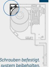
\* Wenn das C-Maß kleiner als 200 mm ist, wird der Safe-Deckel nur mit Schrauben befestigt. Über 200 mm wird das Standard-Scharnier system beibehalten.
