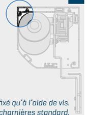
\* Si la dimension C est inférieure à 200 mm, le couvercle du coffre ne sera fixé qu'à l'aide de vis.
