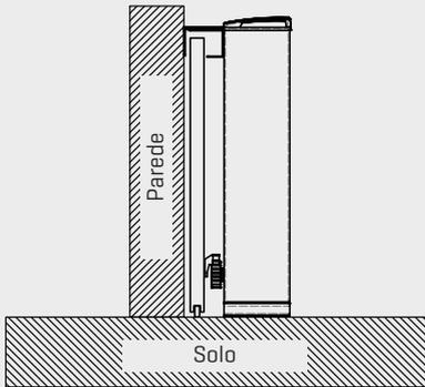
La base del motor queda alineada por el límite inferior de la puerta en el lugar de instalación.
