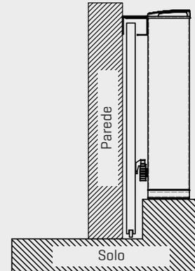
La base del motor está por encima del límite inferior de la puerta en el lugar de instalación.
