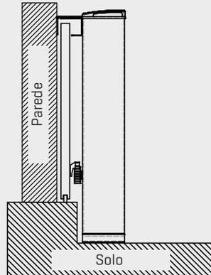
La base del motor queda por debajo del límite inferior de la puerta en el lugar de instalación.
