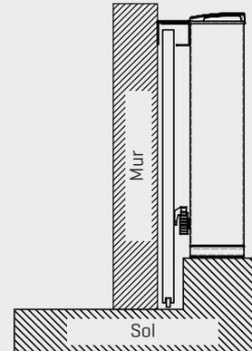
La base du moteur est au-dessus de la limite inférieure du portail sur le site d'installation.
