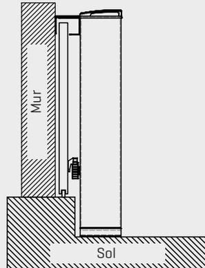
La base du moteur est au-dessous à la limite inférieure du portail sur le site d'installation.
