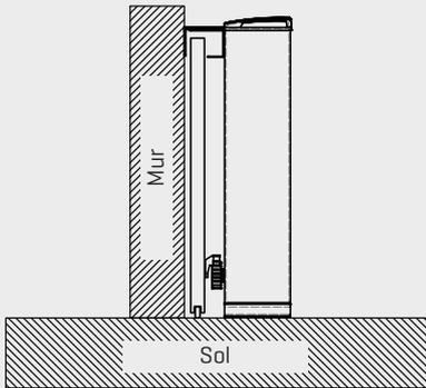
La base du moteur est alignée sur la limite inférieure du portail sur le site d'installation.
