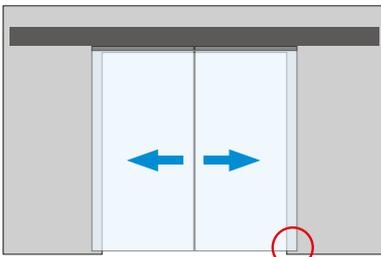
En mode fermé, une légère superposition des vantaux au mur est recommandé pour l'étanchéité, généralement entre 25 et 50 mm.
