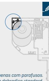
\* Se cota C for inferior a 200mm, a tampa do cofre será fixa apenas com parafusos. Acima de 200mm, mantemos o sistema de dobradiça standard.
