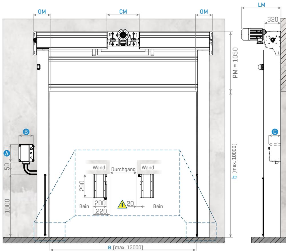
⚠ Um die Beine zu schützen, erfolgt der Einbau 20mm außerhalb des Durchgangs [Maß a].
