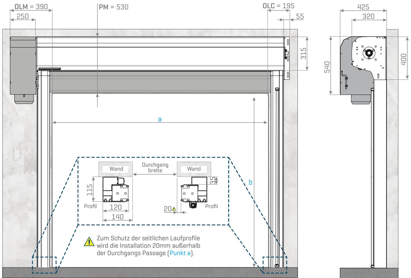
Legende: OLM - Wand Motorseite; OLC - Wand Gegenüberliegende Motorseite; PM - Minimum Sturz
