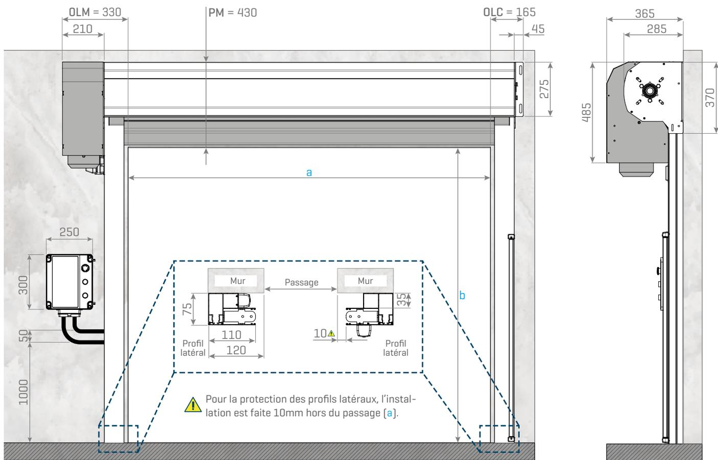
Légende: OLM - Écoinçon côté moteur; OLC - Ecoinçon côté opposé; PM - Linteau minimale
