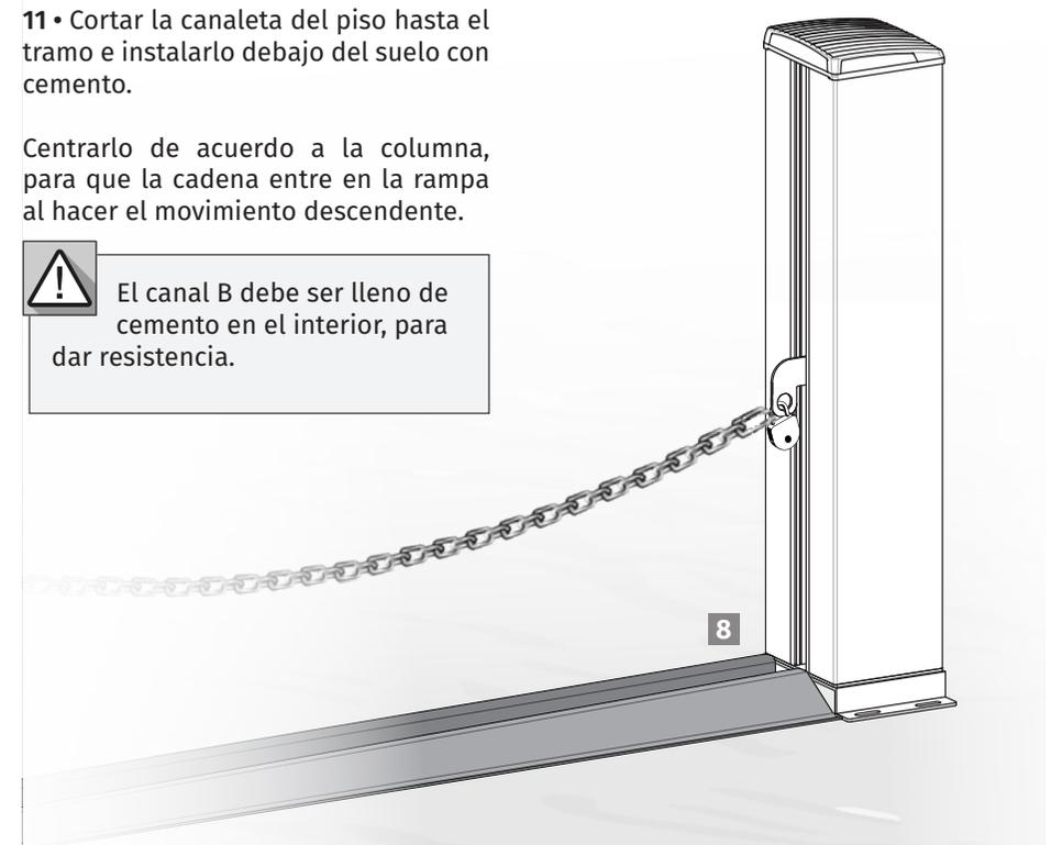
Si eliges otro tipo de canalón (Canalón A), tendrás que hacer una base para fijarlo al suelo.
