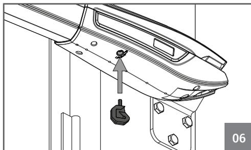
Coloque la llave de desbloqueo en la ranura señalada en la imagen 05 (motor instalado a la izquierda) o 06 (motor instalado a la derecha).
