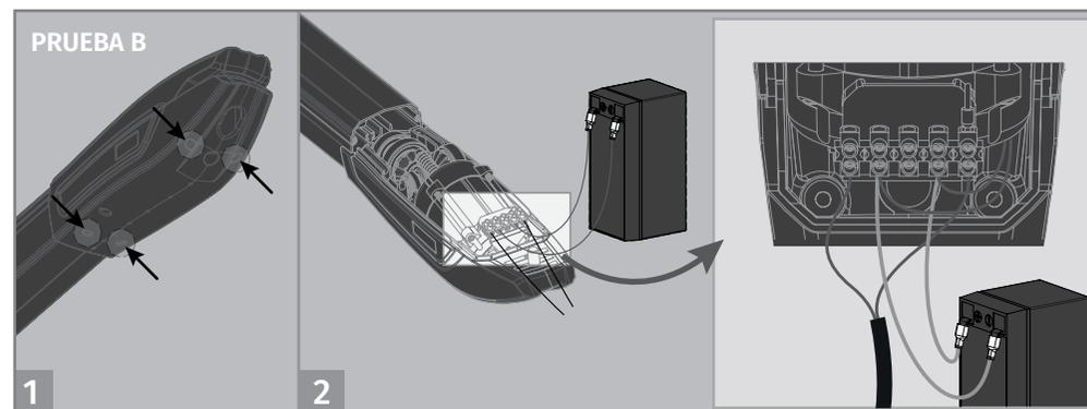
**Prueba B** • Afloje los 4 tornillos para retirar la tapa y acceder a las conexiones internas. Haga las conexiones como se indica en la imagen. Si el motor funciona, el problema estará en el diodo(s) o en el micro(s). Si no funciona, haga la sustitución por un nuevo motor de 24V y vuelva a probar para garantizar que está todo bien.
