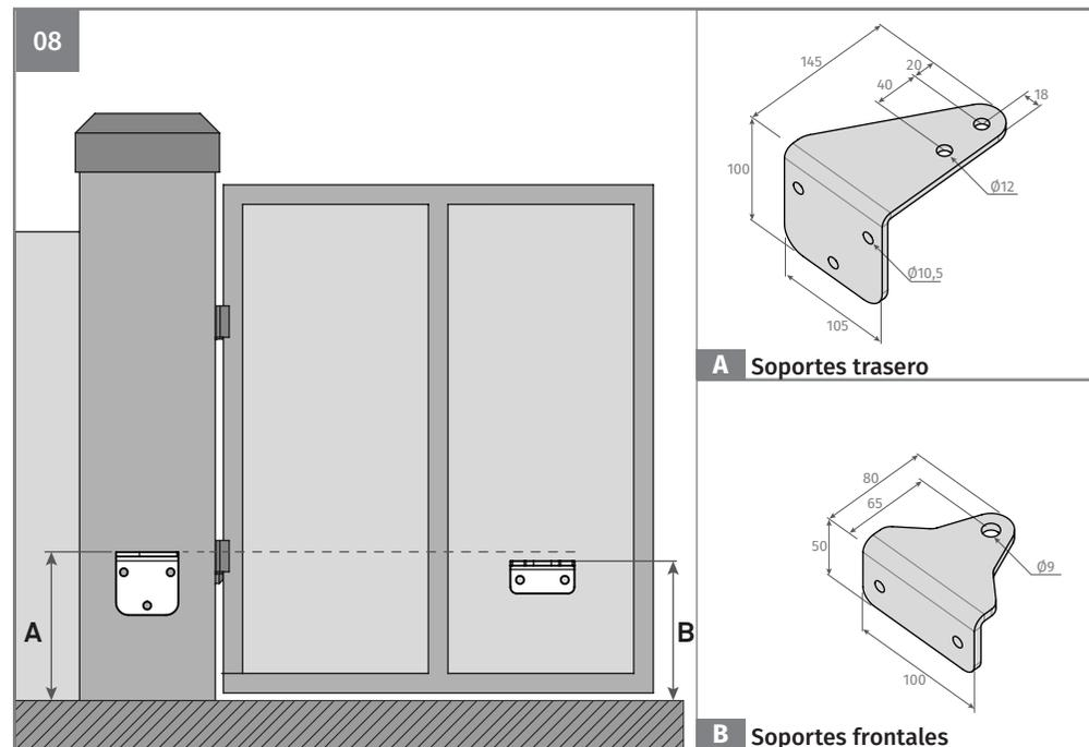
**Cota A** • Distancia vertical desde el suelo hasta la parte superior de la chapa del soporte trasero.
