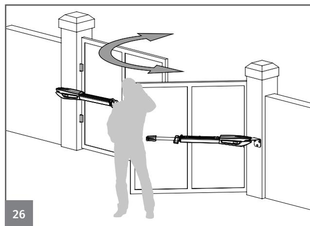
09 • Pruebe el portón manualmente y si fuere necesario vuelve a ajustar los micros, como se indica en los puntos anteriores.
