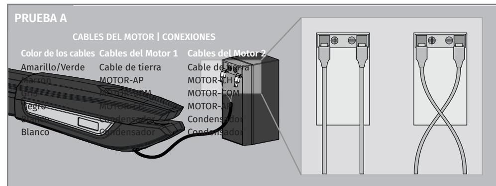
**Prueba A** • Haga las conexiones como se indica en la imagen. Si el motor funciona, el problema está en la central. Si no funciona, haga la prueba B.
