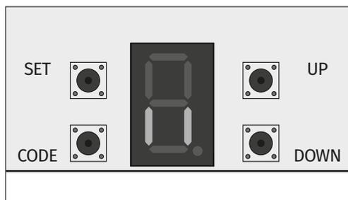
**1** • Al conectar la alimentación, la luz de cortésia se encenderá durante unos segundos y el display mostrará un valor que oscila entre "9" y "0". Posteriormente, la automatización está en modo de espera.
