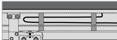
**06.** Ziehen Sie schließlich das Kabel im Inneren der Tür fest an und befestigen Sie es, sodass die Bewegung anderer Komponenten, wie z. B. eines Riemens oder einer Laufwagen, nicht behindert wird.
