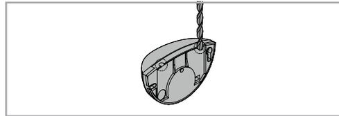
**04.** Das Radar hat oben zwei Kabelausgänge. Wählen Sie bei geschlossenem Radar eine aus und öffnen Sie mit Hilfe eines Bohrers den Durchgang für das Kabel.
