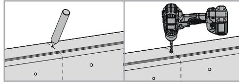
**02.** Markieren und bohren Sie die Oberseite des Gehäuse für den Kabeldurchgang von innen nach außen.
