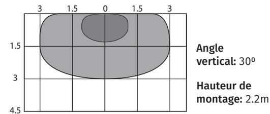
Ajuster l'angle latéral détermine la position de la zone d'action:
