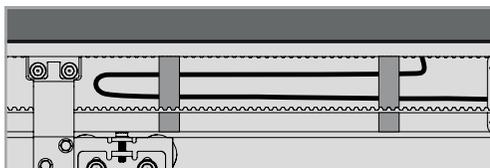
**06.** À la fin, tirer et fixer le câble à l'intérieur du coffre de la porte, de sorte qu'il ne gêne pas le mouvement des autres composants tels que la courroie ou des chariots.
