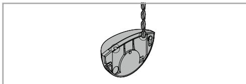
**04.** Le radar dispose de deux sorties de câble dans sa partie supérieure. Choisir une avec le radar fermé et, à l'aide d'une perceuse, ouvrir le passage du fil.
