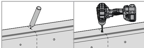
**02.** Marquer et faire un trou dans la partie supérieure du coffre pour le passage du câble de l'intérieur à l'extérieur.
