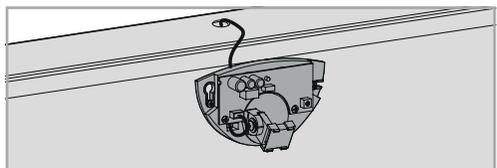
**05.** Rouvrez le radar et le fixer dans les trous précédemment faits. Placez de nouveau le couvercle frontal. Le câble doit passer par le passage réalisé dans la partie supérieure du radar dans le point antérieur (04).
