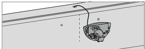
**03.** Faire passer le câble à travers le trou déjà fait, connecter-le dans la borne existante à l'intérieur du coffre et dans la carte de raccordements, à l'intérieur du coffre (schéma de connexions).
