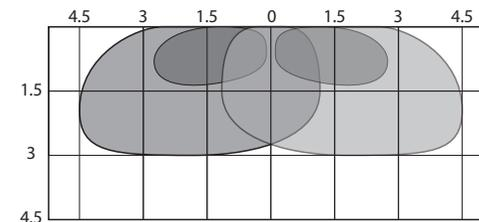
Ajuster l'angle vertical détermine la profondeur de la zone d'action:
