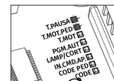
**04** • Les **LED T.MOT.PED** et **LED T.PAUSA** cessent de clignoter en alternance et se mettent à clignoter au même temps.
