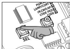
**02** • Appuyer sur le bouton **SEL**, les fois nécessaires, jusqu'à ce que **LED T.MOT.** clignote.
