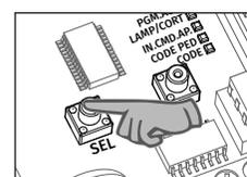
**02** • Appuyer sur le bouton **SEL**, les fois nécessaires, jusqu'à ce que **LED LAMP/CORT** clignote.
