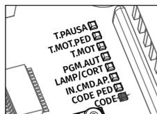
**03** • Le **LED CODE PED** reste allumé en permanence, signalant la réussite de la programmation.
