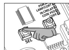
**05** • Maintenant, appuyez sur le bouton **SEL**, les fois nécessaires, pour sélectionner le niveau de force souhaitée.
