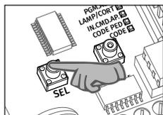
**02** • Appuyer sur le bouton **SEL**, les fois nécessaires, jusqu'à ce que le **LED CODE PED** clignote.
