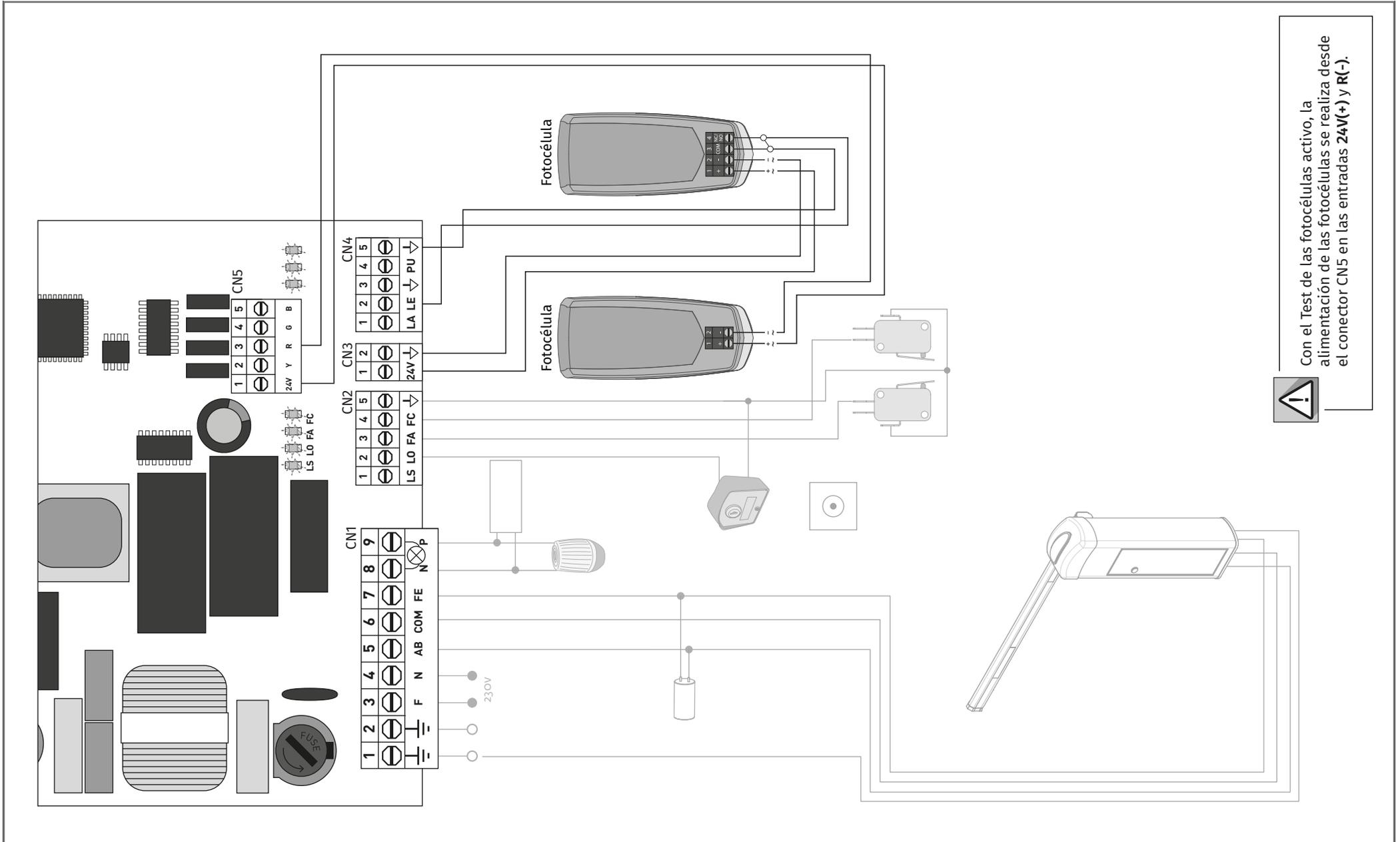
Con el Test de las fotocélulas activo, la alimentación de las fotocélulas se realiza desde el conector CN5 en las entradas 24V(+) y R(-).
