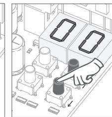
04 • Aparece la función definida de fábrica. Si desea, cambie la función de 00 o 01 utilizando ↑ ↓.
