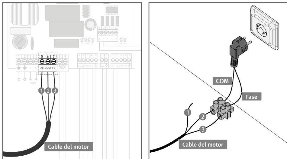
**01** • Retire los 3 hilos de conexión del motor en la central.
