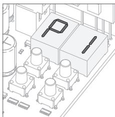
04 • Cuando surge P1, la programación automática terminó. Si desea programar P1 continúe con el paso 03 de menú P1 (pág. 6B). Para salir de la programación presione ↑↓ simultáneamente.
