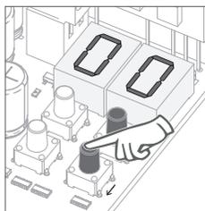
04 • Aparece la función definida de fábrica. Si desea, cambie la función para 00 o 01, utilizando ↑ ↓.
