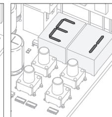
09 • Aparece E1. Para programar E1 continúe con el paso 3 del menú E1 (p.11A). Para salir de la programación presione ↑ ↓ simultáneamente.
