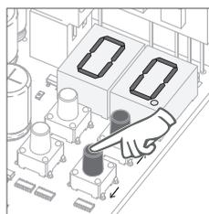
08 • Aparece la función definida de fábrica. Si desea, cambie la función de 00 o 01 utilizando ↑ ↓.
