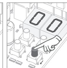
05 • Aparece la función de fábrica. Si lo desea, cambie la función a 00 o 01 utilizando ↑ ↓.
