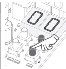
07 • Aparece la función definida de fábrica. Si desea, cambie la función de 00 o 01 utilizando ↑ ↓.
