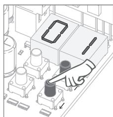
**04** • Surge a função definida de fábrica. Se pretender, altere a função para 00 ou 01, utilizando ↑ ↓.
