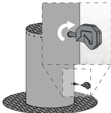
Pour déverrouiller la borne, insérez la clé dans la fente et tournez dans le sens des aiguilles d'une montre.
