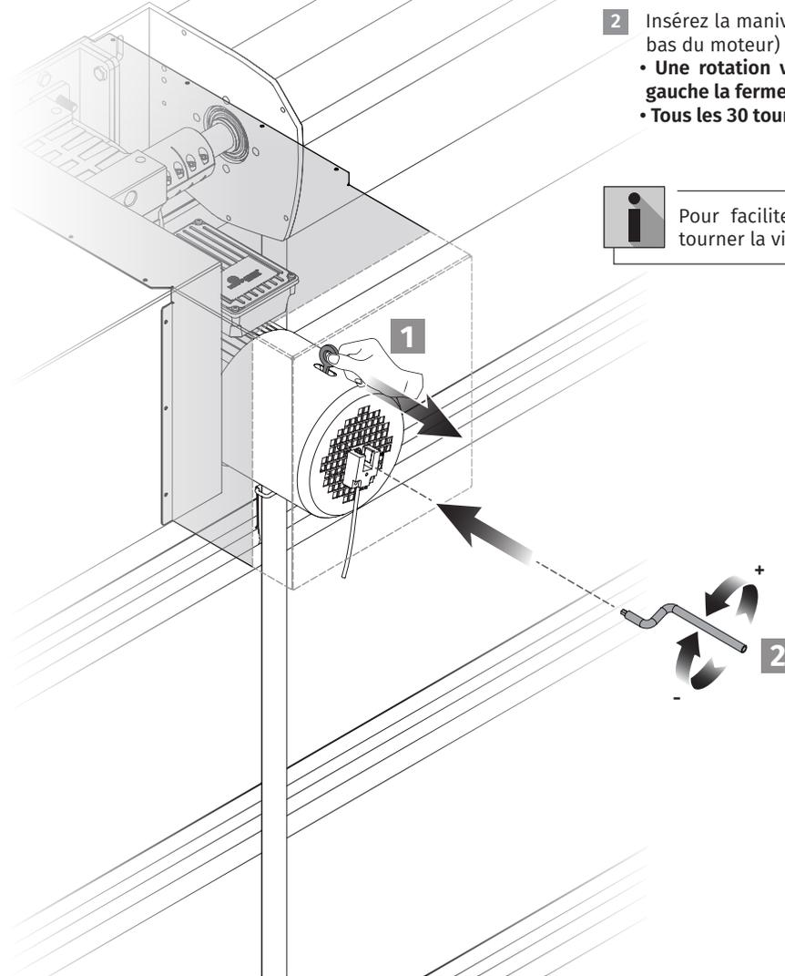
Le moteur est doté d'un levier de déclenchement qui permet d'ouvrir/de fermer manuellement la porte à l'aide d'une manivelle.
