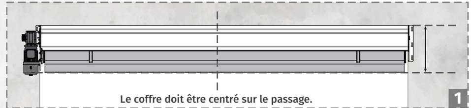
Le coffre doit être centré sur le passage.
