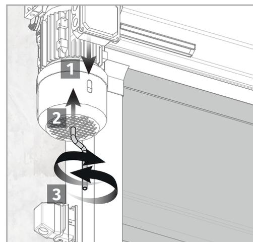
Pour ouvrir ou fermer la porte manuellement, il suffit de tirer et de maintenir le levier de déverrouillage et d'insérer la manivelle pour tourner la vis installée dessous le moteur (voir image).
