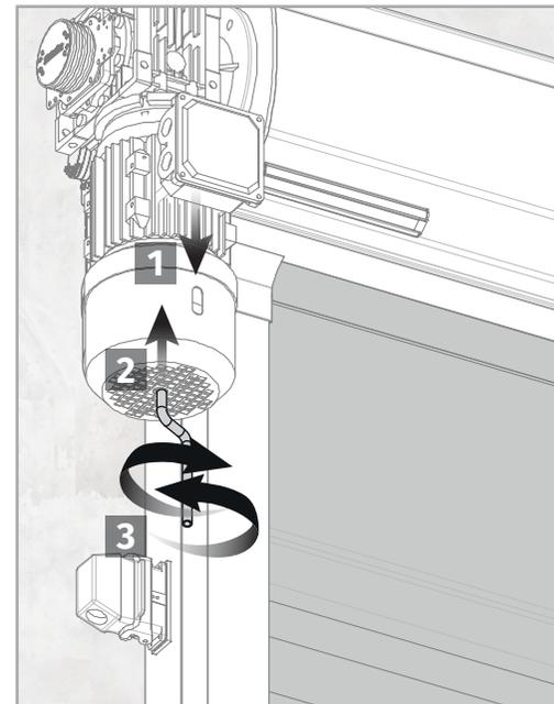
Para abrir o cerrar manualmente la puerta, simplemente tire y sostenga la palanca de desbloqueo e inserte la palanca para girar el tornillo instalado en la parte inferior del motor (ver imagen).
