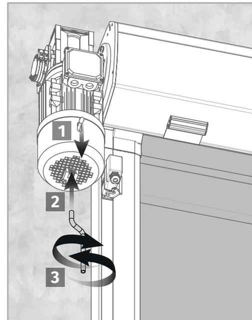
Pour ouvrir ou fermer la porte manuellement, il suffit de tirer et de maintenir le levier de déverrouillage et d'insérer la manivelle pour tourner la vis installée dessous le moteur (voir image).
