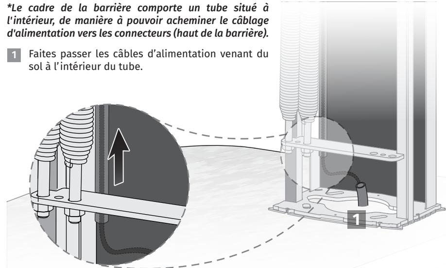
2 Lorsque le câble d'alimentation atteint la surface de la barrière, connectez les fils au connecteur situé sur la plaque de support de l'électronique. Connectez le fil de terre au connecteur central comme indiqué sur l'illustration.
