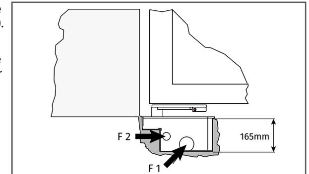
3 • Insérer l'ourlet pour le passage du câble d'alimentation à l'intérieur de l'orifice (F2).
