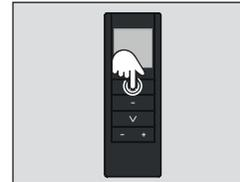
**01** • Halten Sie die Taste **ÖFFNEN** eines bereits programmierten Handsender 15 Sekunden lang gedrückt.
