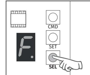
2 • Im Display erscheint F. Drücken Sie die Taste **SEL** so oft wie nötig, bis im Display b angezeigt wird.
