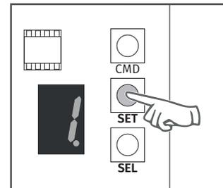
4 • Das Display zeigt den Wert 0 oder 1 an, der die Option angibt, in der die Steuerung derzeit konfiguriert ist. Wechseln Sie mit der Taste SEL zur gewünschten Option. Drücken Sie SET einmal, um diese Option zu speichern.
