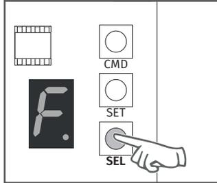
**2** • Im Display erscheint **F**. Drücken Sie die Taste **SEL** so oft wie nötig, bis im Display **C** angezeigt wird.
