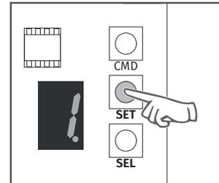
4 • Das Display zeigt den Wert 0 oder 1 an, der die Option angibt, in der die Steuerung derzeit konfiguriert ist. Nutzen Sie die Taste **SEL**, um zur gewünschten Option zu gelangen. Drücken Sie zur Bestätigung **SET**.
