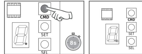
Drücken Sie **CMD** für 8 Sekunden (während dieser Zeit wird der LED Anzeigepunkt leuchtend bleiben). Am Ende dieser Zeit blinkt der LED Anzeigepunkt zweimal und zeigt damit an, dass alle Befehle aus dem Speicher gelöscht wurden.
