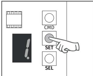
4 • Das Display zeigt den Wert zwischen 0 oder 4 an. Nutzen Sie die Taste **SEL**, um zur gewünschten Option zu gelangen. Drücken Sie die Taste **SET** einmal, um diese Option zu speichern.
