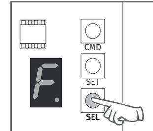
2 • La pantalla va a mostrar F. Presione **SEL** las veces necesarias hasta que la pantalla muestre el menú al cual desea acceder. Presione **SET** para configurar.
