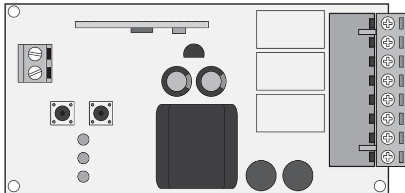
Central electrónica MC8, para a automação de toldos, com possibilidade de conexão de Luz de permanência, com funcionamento mediante Rádio-comando e Sensor Wireless (Sol/vento/Chuva).
