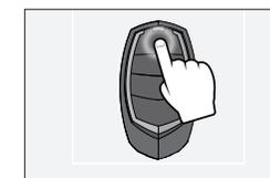
03 • Envoyer le code avec la radiocommande à programmer.
