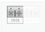
• **INIB** - Esta entrada tem como função desativar o funcionamento da entrada **SAFETY**, através de um contacto **NO** para ligação de botoneira ou contacto magnético.
