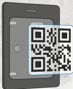
Pour effectuer n'importe quel type de configuration sur l'appareil, il suffit de scanner, à l'aide du **MQR340**, les codes QR de ce manuel correspondant à la configuration/modification que vous souhaitez effectuer sur l'appareil.
