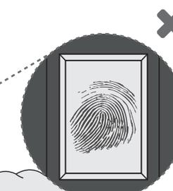
Normalmente o núcleo da impressão digital encontra-se alinhado com a linha de união da unha ao dedo, pelo que regra geral, deve colocar o dedo de forma que a extremidade da unha esteja alinhada com o centro do sensor.
