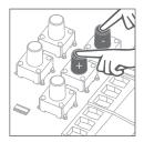
02 · Navegue por las funciones usando +/y haga clic en **MENÚ** para ingresar en la función deseada.
