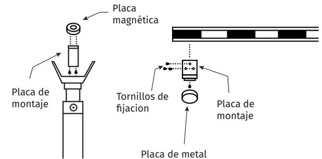
**PASO 1** • Instale una placa de acero en la barrera con los tornillos suministrados.
