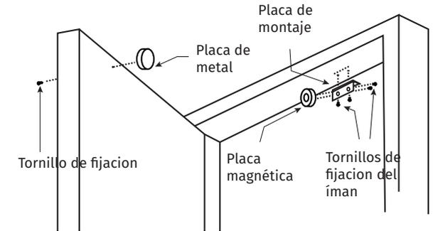
**PASO 1** • Instale la placa de acero con 1 tornillo suministrado en la puerta.
