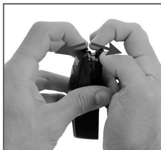
**03** • Ouvrez la photo cellule en séparant les pièces par la partie inférieure.
