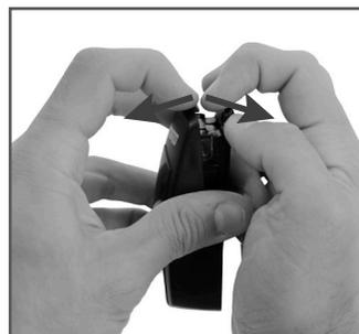
**03** • Öffnen Sie die Lichtschanke, indem Sie die Teile von unten trennen.
