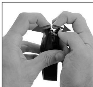
**03** • Ouvrez la photo cellule en séparant les pièces par la partie inférieur.
