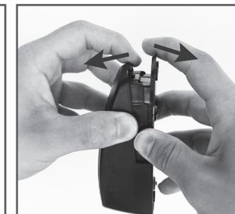
**03** • Öffnen Sie die Lichtschränke, indem Sie die Teile von der Unterseite trennen.
